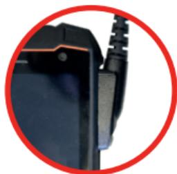
13 connecteurs PIN connectés à l'interface ISM - en utilisant l'exemple de l'**IS530.2**.
