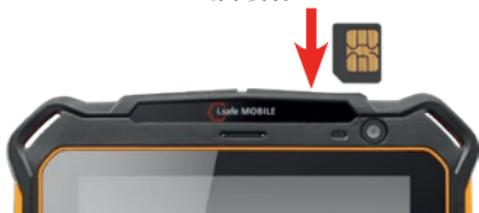
» 打开SIM卡插槽上的IP PLUG。
