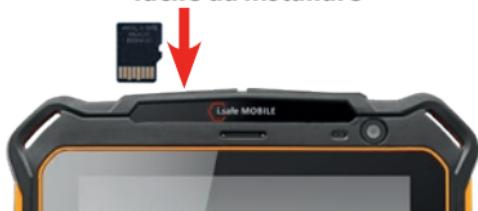
» Aprire il IP-plug dello slot SD.
